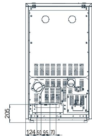
Si consiglia vivamente di lavare l'intero impianto prima di collegarla al fine di eliminare residui e depositi. Installare sempre a monte della stufa delle saracinesche di intercettazione al fine di isolare la stessa dell'impianto idrico qualora fosse necessario muoverla o spostarla, per eseguire la manutenzione ordinaria e/o straordinaria. Collegare la stufa utilizzando delle tubazioni flessibili per non vincolare eccessivamente la stufa all'impianto e per permettere dei leggeri spostamenti
